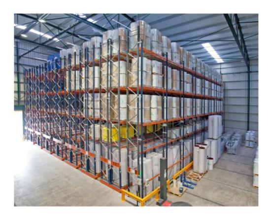
L'utilisation de rayonnages sur bases mobiles Movirack permet d'optimiser l'installation
