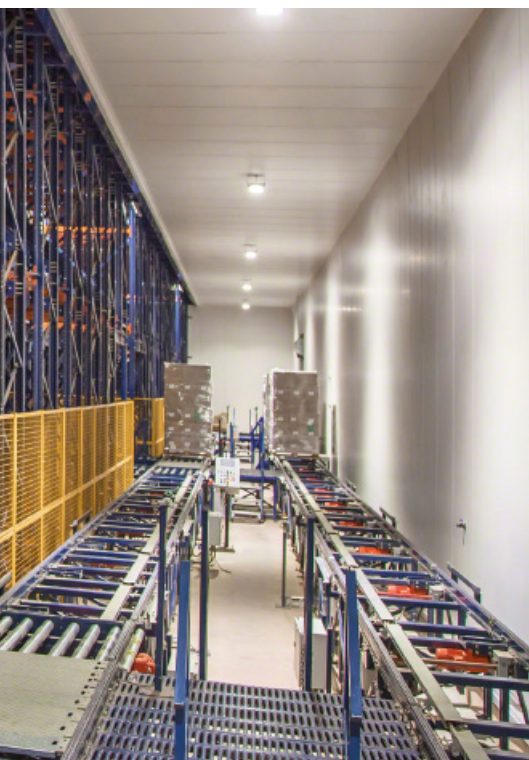
1. Le Pallet Shuttle dans la nacelle du transstockeur attend l'arrivée de la palette provenant du poste d'inspection.
