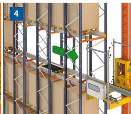
4. Le transstockeur attend que le Pallet Shuttle termine et monte de nouveau automatiquement à la nacelle.
