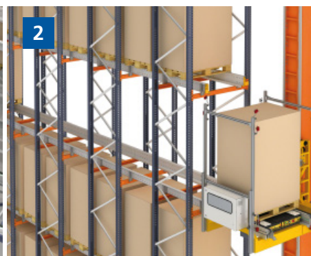
2. Le transstockeur prend la palette à l'aide des chaînes installées dans la nacelle et se dirige ensuite vers le canal assigné par le WMS.
