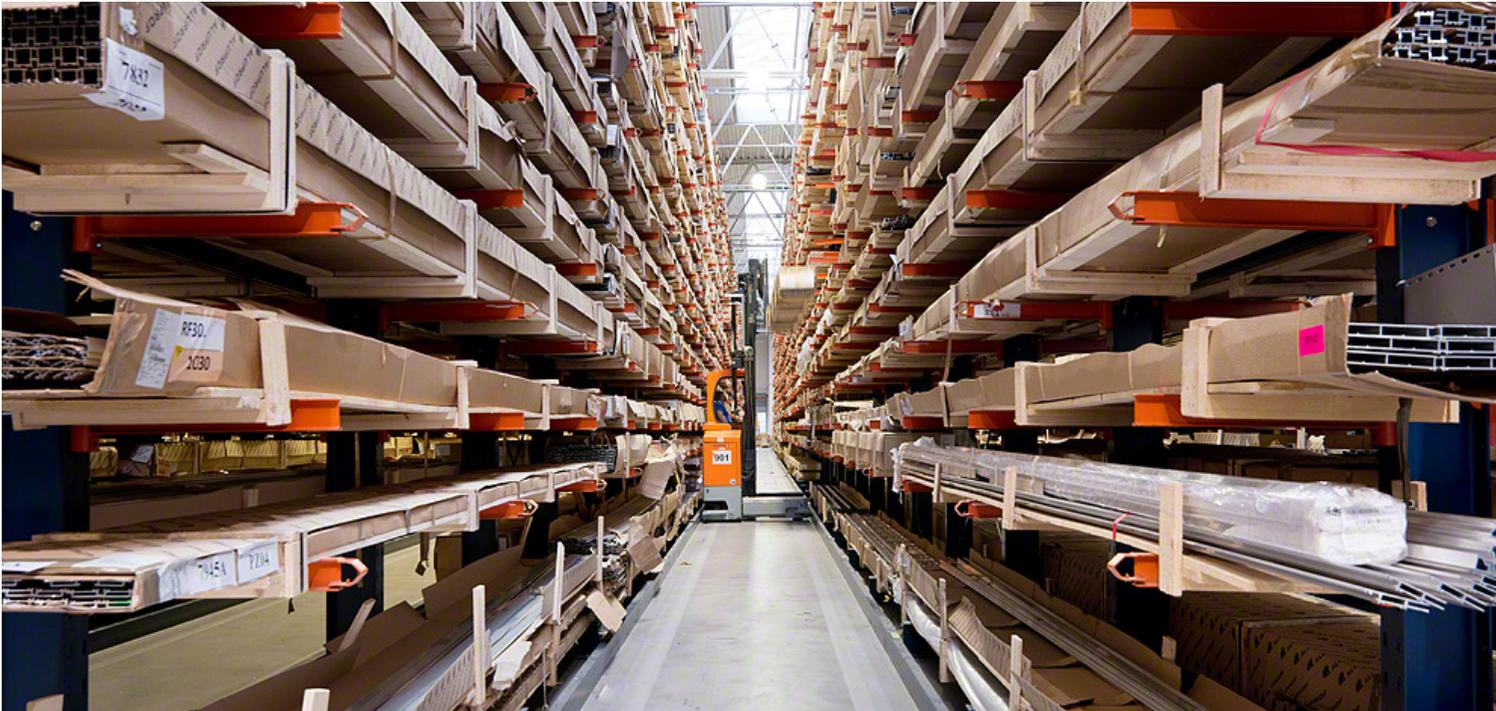
déposées. Des chariots multidirectionnels sont utilisés pour manipuler la marchandise. Ces derniers permettent de circuler avec une grande stabilité à l'intérieur des allées étroites, malgré le transport de matériaux pouvant mesurer jusqu'à 12 m de long. Pour que les chariots circulent à l'intérieur des allées en toute sécurité et afin d'éviter les éventuels impacts contre les rayonnages et la marchandise, des rails de guidage ont été installés dans le sol de chaque allée de stockage.
