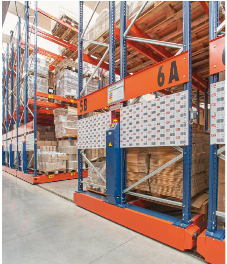
norme italienne NTC 2008 et de la norme NF EN 16681. Le système est donc spécialement protégé des accidents et dommages possibles dans une zone à haut risque de mouvements sismiques.
