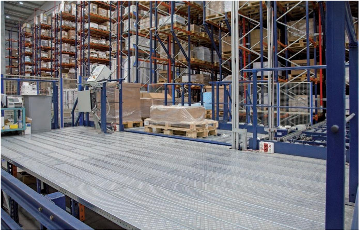
Outre le poste de picking, qui est installé sur la partie avant, 44 canaux dynamiques pour palettes ont été mis en place au niveau du sol
