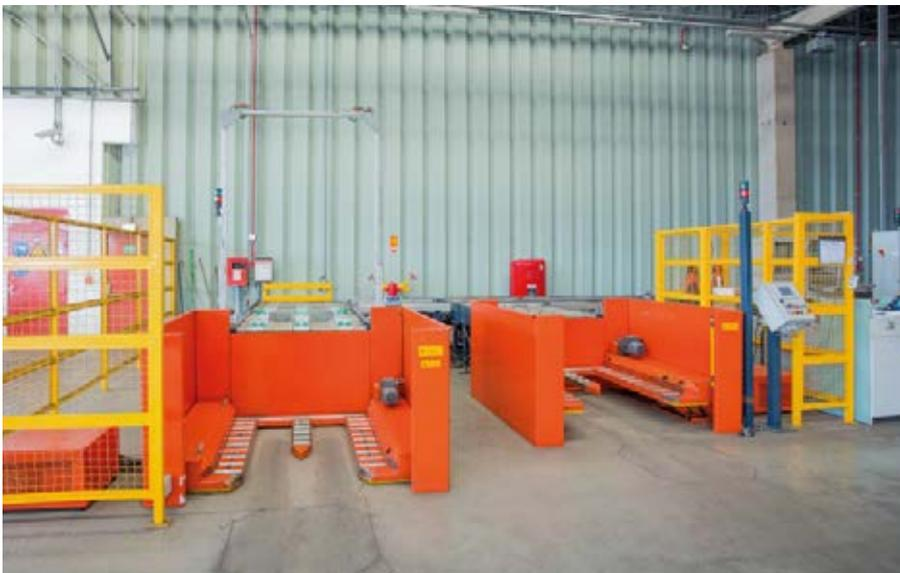
La marchandise qui sort de l'entrepôt peut être acheminée vers la zone de picking installée en périphérie, ou directement vers le convoyeur de sortie lorsque la palette complète doit être expédiée
