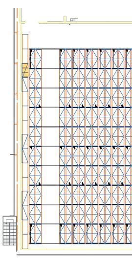
L'entrepôt d'Iberfresco (entreprise de conditionnement de légumes surgelés), s'est équipé des rayonnages bases mobiles Movirack Mecalux pour exploiter au maximum toute la surface et stocker tous ses produits dans une seule installation.
