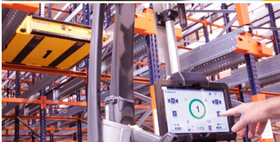
Les processus de stockage sont gérés au moyen de tablettes à l'aide desquelles les ordres sont donnés aux navettes Pallet Shuttle. Ces tablettes sont dotées d'une interface tactile et d'un logiciel très intuitif dont l'utilisation ne nécessite pas de formation particulière. Chaque tablette peut interagir avec toutes les navettes de l'entrepôt suivant un protocole de priorités.
